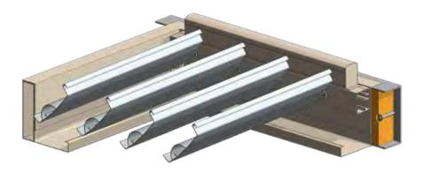
INSIDE FACE MUST BE FLUSH TO FIT THE OPENING ROOF GUTTER AND PIVOT SYSTEM ONTO.
